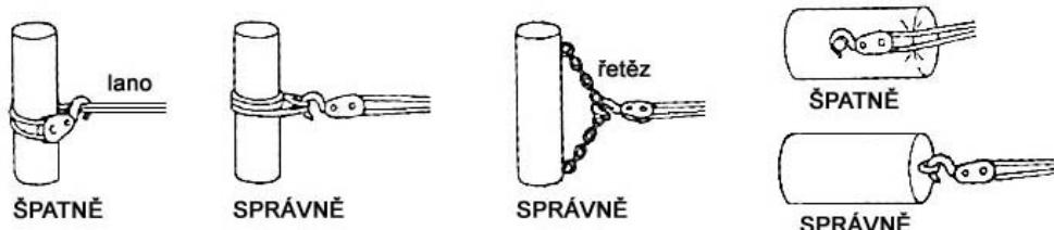
Pečlivě zkontrolujte technický stav kladkostroje, dotažení šroubů, zajištění čepů, zápatky rohatku atd.. Kotvíci hák (9) zahákněte na závěsný prvek s odpovídající nosností.
